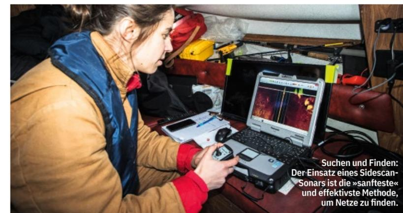
Suchen und Finden: Der Einsatz eines Sidescan-Sonars ist die »sanfteste« und effektivste Methode, um Netze zu finden.
